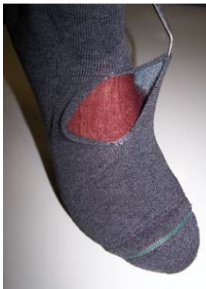
Calza doppia realizzata con il nuovo brevetto Busi applicabile su macchine con platorello d'aghi.
